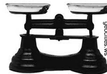
Balança mecânica comercial
